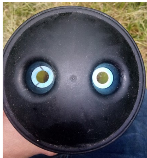
Détail des joints de plomberie 12/17 placés aux orifices d'entrée d'un piège
